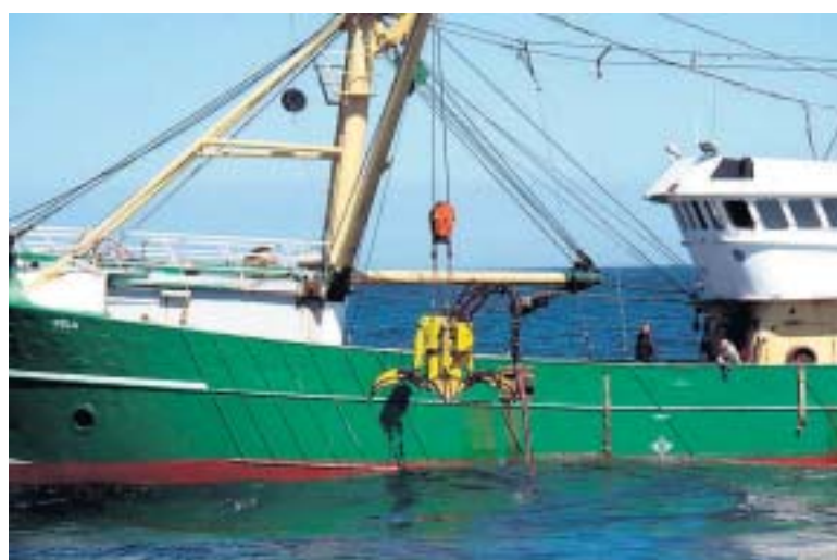
De 'Bela' met poliepgrijper, boven het wrak van de Scott. FOTO BEN STIEFELHAGEN
