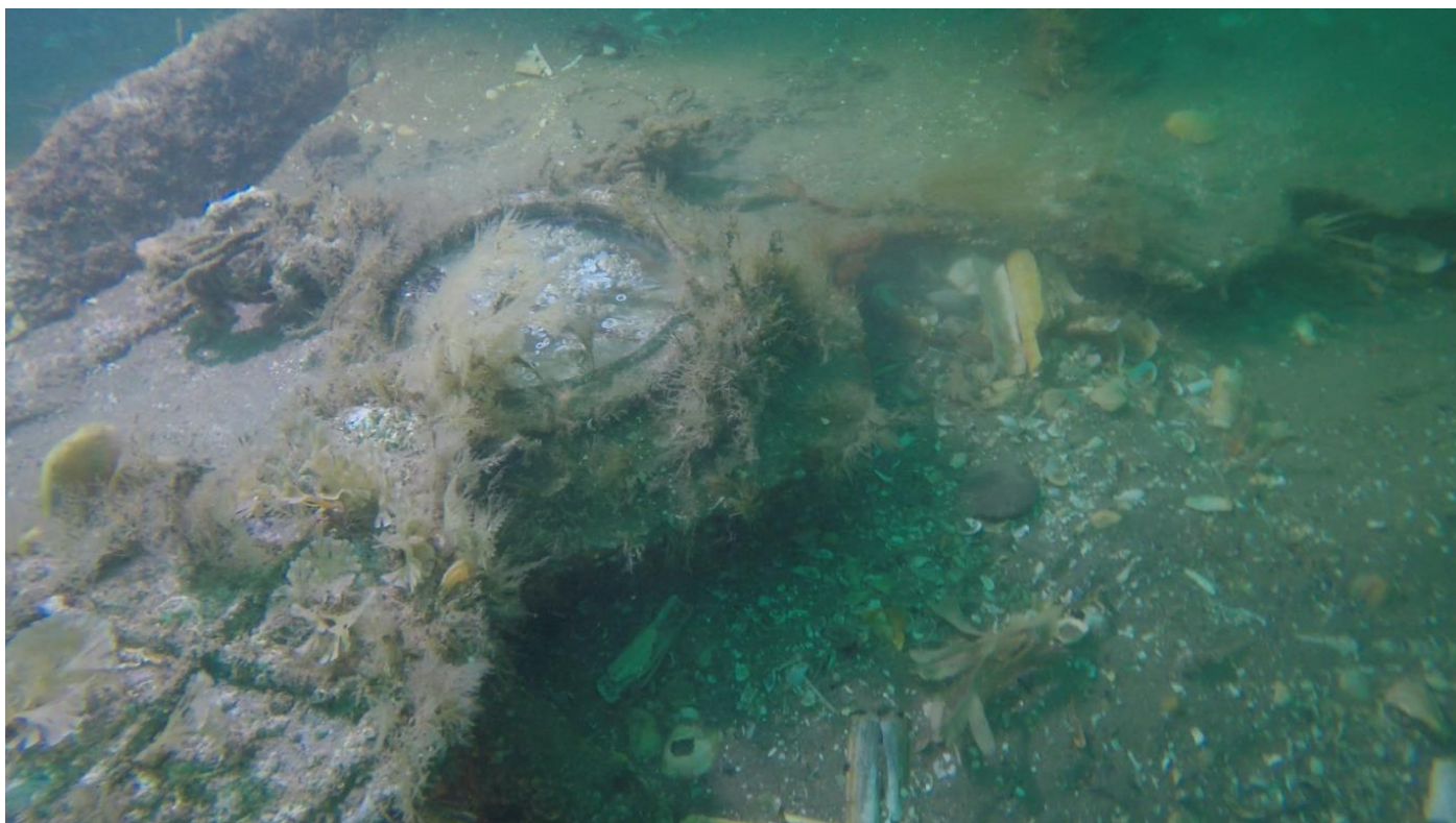
Een patrijspoot met deksel. Het kruis in de linker onderhoek is de verstevigde deksel (stormshutter). Deze moet bij glasbreuk of tijdens een storm gesloten worden.
