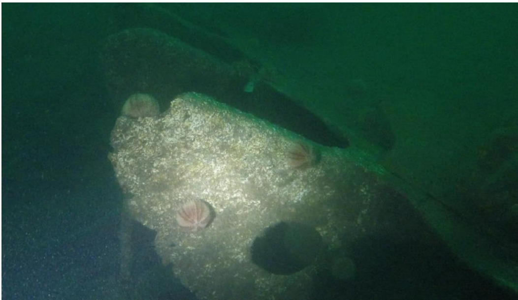
Foto links: De dubbele bodem van de Somali. De huidbeplating ligt open gescheurd op de bodem. Het schip ligt ca 30 graden over bakboord.
